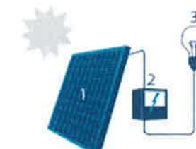
1 Zonnepaneel 2 Omvormer 3 Elektrische panelen
